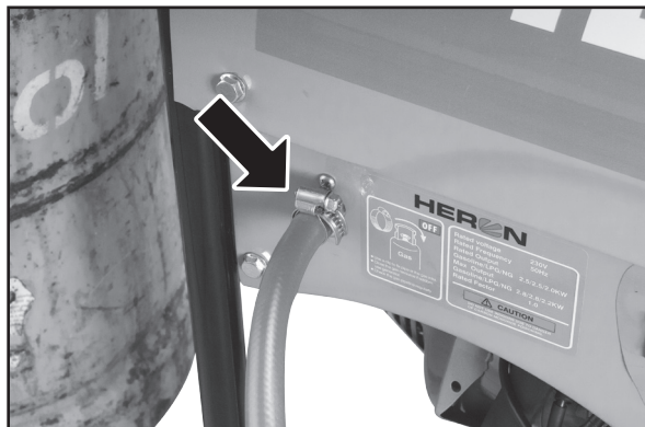
Spôsob pripojenia plynovej hadice k elektrocentrále Obr. 14
