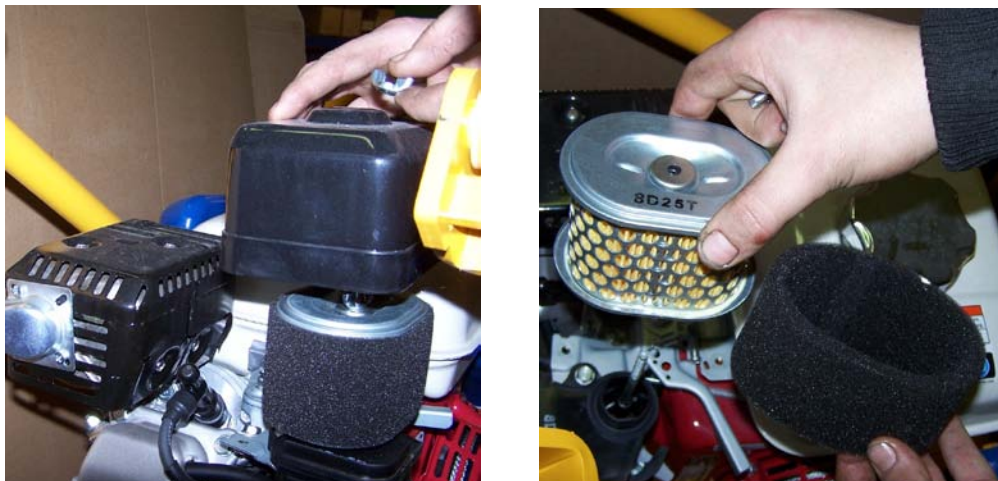
Obr. Kontrola čističe vzduchu motoru
