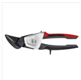
Ruční nůžky na plech s pákovým převodem
